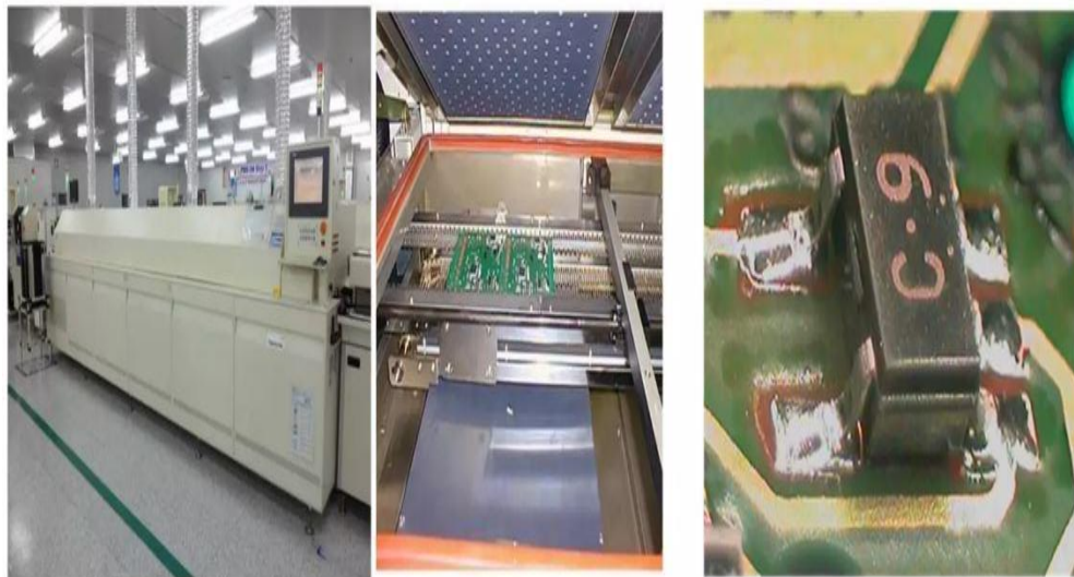
Gambar 14. Reflow Oven dan PCB Yang Sudah Rekat Dengan Komponen
