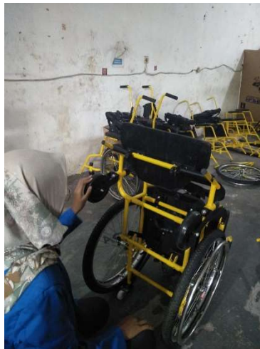
Gambar 2. Proses pengukuran ban depan dan bantalan duduk kursi roda
